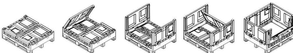
Cargo Fold 700 geschlitzt mit Klappe und Kufen, speziell für den Lebensmittelbereich, für die unterschiedlichsten Transport- und Lagerbedürfnisse bereit. Der Cargo Fold 700 ist komplett zusammenklappbar. Eine Anordnung das, im Falle von transportieren von leeren Container oder im Lagerhaus aufzubewahren, sie bis zu 63% Volumen ersparen wird. Ein Stapel von 8 gefalteten Container ist genau so hoch wie 3 offene Container.
