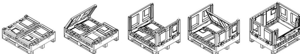
Cargo Fold 700 mit kufen, für die unterschiedlichsten Transport- und Lagerbedürfnisse bereit. Der Cargo Fold 700 ist komplett zusammenklappbar. Eine Anordnung das, im Falle von transportieren von leeren Container oder im Lagerhaus aufzubewahren, sie bis zu 63% Volumen ersparen wird. Ein Stapel von 8 gefalteten Container ist genau so hoch wie 3 offene Container.
