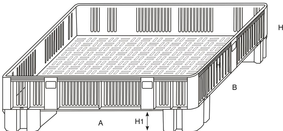
Die neue CARGOPALLET 280 ist ein Behälter, speziell entwickelt für Transport und Lagerung von Lebensmittel. Hergestellt aus Lebensmittel-lechten Material, Boden und Seiten durchbrochen, ist dieser Behälter robust und übereinander Stapel bar. Bis zu 150 Kg kann dieser Behälter, ohne das der Boden sich verformt. Dies ist ideal für die automatische Lagerung von Lebensmittel (Gemüse, Obst, Fleisch, Wurstware usw.).
