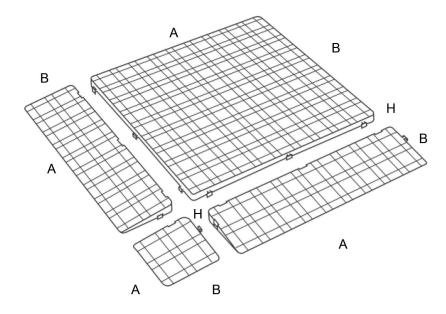
Zusammensetzbarer Fussbodenroste mit Einhaksystem zwischen den diversen Elementen für eine einfache Verlegung. Säure-, Lösungsmittel- und Fettbeständig. Bemessungsbetriebsspannung 3 Kv. Epsilon Plus ist komplett mit seitlichen und Eckverbindungsstück für einen noch praktischeren Bodenbelag.
