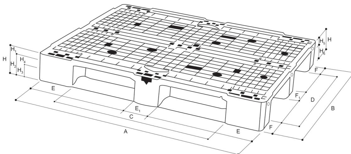
Il pianale e le traversine dei PALLET monoblocco My-E sono costampate in un corpo unico. Le pareti laterali delle traversine sono perfettamente verticali e sono ottimali per utilizzo in sistemi automatizzati di trasporto e di stoccaggio. I pallet possono anche essere forniti con bordino perimetrale di contenimento del carico. Grazie alla sua struttura grigliata, risulta facile da pulire e al tempo stesso impermeabile ai liquidi.
