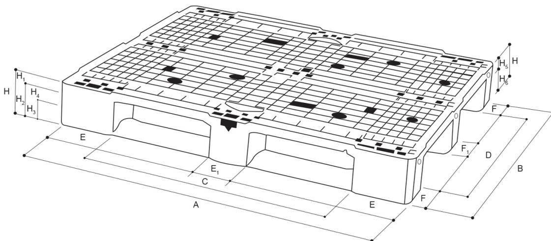
Wir präsentieren den Monoblock Kunststoffpalette Typ My-E zu präsentieren. Kufen und Plattform werden in ein einzigen Körper gespritzt. Die seitlichen Wände der Kufen sind perfekt Vertikal und sind optimal für Transport, gebrauch in automatisierte Systeme und Lagerung. Diese Kunststoffpaletten sind auch mit Aufkantung erhältlich. Dank seiner gegrillten Struktur ist es leicht zu reinigen und gleichzeitig undurchlässig für Flüssigkeiten.
