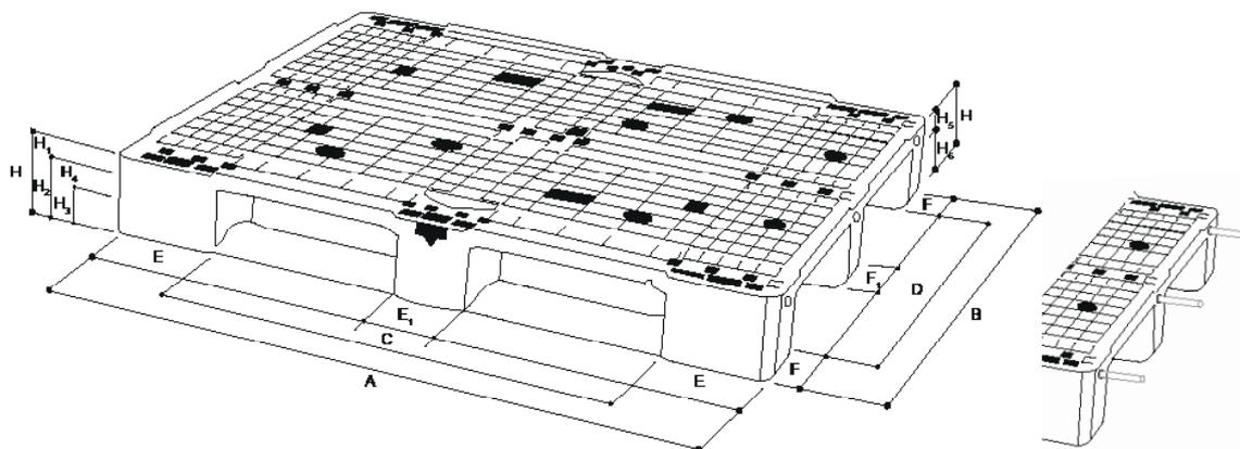
Wir präsentieren den Monoblock Kunststoffpalette Typ My-E zu präsentieren. Kufen und Plattform werden in ein einzigen Körper gespritzt. Die seitlichen Wände der Kufen sind perfekt Vertikal und sind optimal für Transport, gebrauch in automatisierte Systeme und Lagerung. Diese Kunststoffpaletten sind auch mit Aufkantung erhältlich. Dank seiner gegrillten Struktur ist es leicht zu reinigen und gleichzeitig undurchlässig für Flüssigkeiten.
