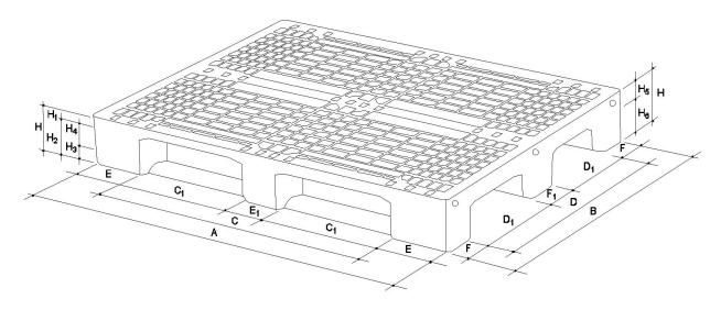
La nuova versione del PALLET My-E 800x1200 è stampata in monoblocco. Le pareti laterali delle traversine sono perfettamente verticali, quindi ottimali per utilizzo in sistemi automatizzati di stoccaggio e trasporto.
