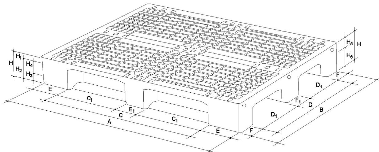
Die neue My-E 800x1200 Version ist aus einem Teil gespritzt. Die seitlichen Wände der Kufen sind perfekt Vertikal und sind optimal für Transport und gebrauch in automatisierte Systeme und Lagerung.
