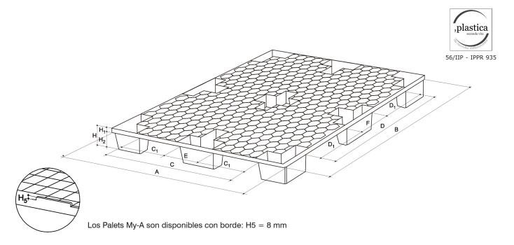
El Palet My-A 1135x1135 es el instrumento ideal para quienes necesitan paletizar mercancía destinada al transporte en containers. En efecto, la medida 1135 mm permite cargar dos pallets uno al lado del otro en el interior de un container.
