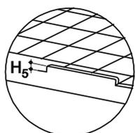
Nella versione con bordino di contenimento:  $H_5 = 8 \text{ mm}$
