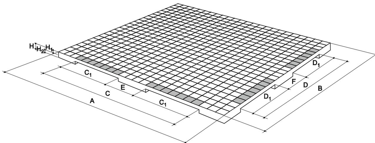
La plataforma es una solución óptima para obtener pavimentaciones fácilmente removibles. Superficie empujillada antideslizante, resistente incluso a la acción de la humedad, no requiere mantenimiento.
