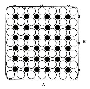
Los elementos autocomponibles Sigma realizados en resina especial a prueba de choques de color verde, son particularmente indicados para la movimentación de industrias gráficas y mecánicas por estar en condiciones de absorber al máximo las vibraciones de las instalaciones y de atenuar los ruidos.
