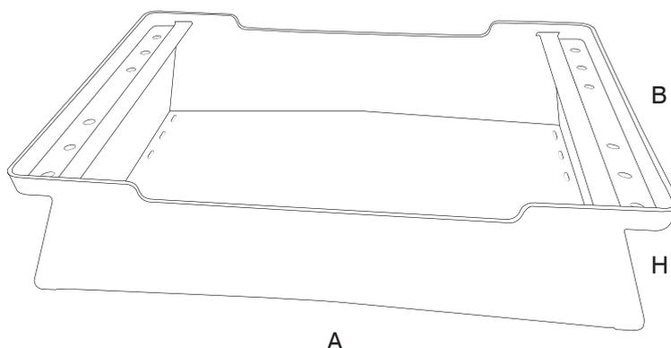
El contenedor apilable ZETA 2, gracias a su estructura con superficie interna inclinada y los orificios de drenaje ubicados en el fondo, está diseñado específicamente para todos los procesos que involucran el drenaje de líquidos, tales como: industria alimentaria y pesquera.
